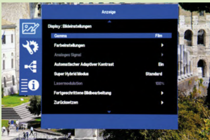
Unter Display: Bildeinstellungen wird der „Automatische Adaptive Kontrast“ eingeschaltet. Für den „Super Hybrid Modus“ stehen die Modi „Aus“, „Standard“ und „Erweitert“ zur Verfügung.
