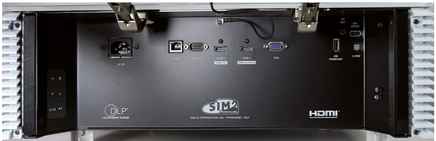
Alle Anschlüsse befinden sich auf der Rückseite unter einer Klappe aus Kristallglas. Eine HDMI-Schnittstelle unterstützt HDMI 2.0 und HDCP 2.2, die zweite ist nur HDMI-1.4-fähig. VGA ist vorgesehen, um einen PC anzuschließen. RS232-C dient der Steuerung. Mit 12V-Out kann eine Motorleinwand verbunden werden, die automatisch ein-/ausfährt, wenn der Projektor ein- oder ausgeschaltet wird. Die USB-Schnittstellen sind für Updates und zur Stromversorgung externer Geräte vorgesehen, wie dem Laden einer 3D-Brille.
