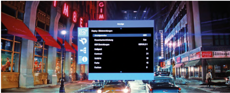
Je nach Film und den darin hinterlegten Metadaten ändern sich die Einstellungen im On Screen Display (OSD) für Helligkeit, Kontrast und Farbe. Ursache ist das dynamische Tone Mapping mit den hinterlegten PQ-Kurven.
